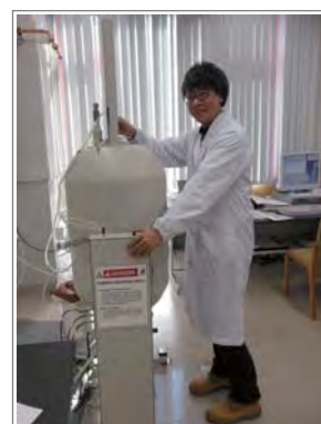
写真3: NMRを観測するために超伝導磁石内に測定試料を挿入している。
