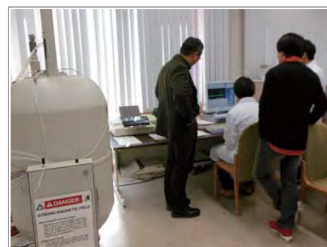
写真4: 制御の分光器を用いて NMR スペクトルを観測する。
